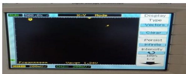
Şəkil 2. Nasosun mancanaq dəzgahının dayanmış halına uyğun gələn təcrübi alınmış siqnal
