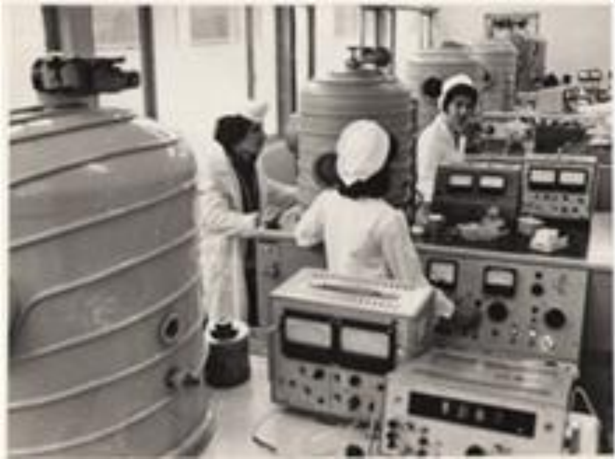
Kosmik cihazqayırmanın element bazası yaradılır (vakuum tozlandırıcı qurğuları)
